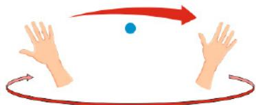
Chcete-li zapnout turbínu zařízení nebo zvýšit její rychlosť, několikrát pohybujte rukou zleva doprava. S každým pohybem dlaně se změní barva diody symbolizující aktivní rychlosť.
