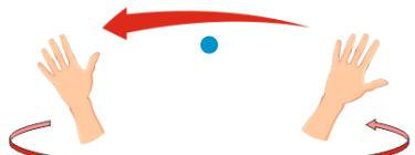
Aby wyłączyć turbinę urządzenia lub zmniejszyć jej bieg, przesuwaj dlonią od prawej do lewej kilkakrotnie, aż zgaśnie dioda LED symbolizująca prędkość.
