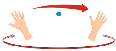
Aby włączyć turbinę urządzenia lub zwiększyć jej bieg, przesuń dlonią od lewej do prawej kilkakrotnie. Z każdym ruchem dloni zmieni się kolor diody symbolizującej aktywny bieg.
